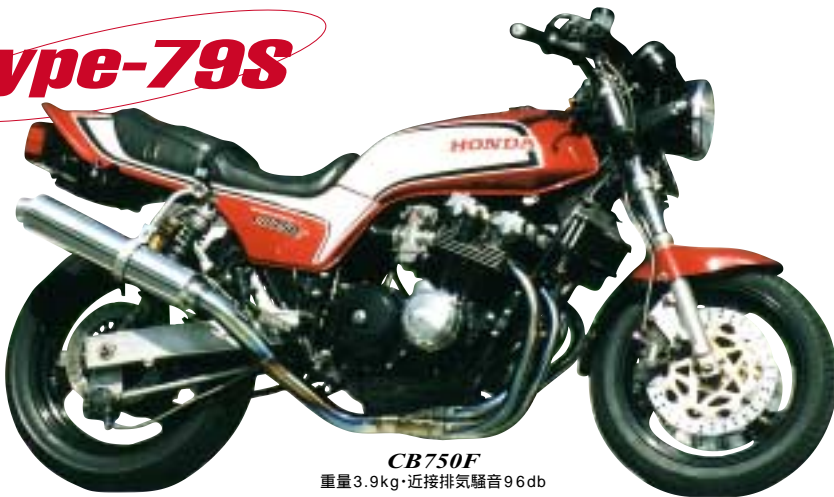
CB750F 重量3.7kg・FIM方式測定値102db (法定方式測定値98db)
